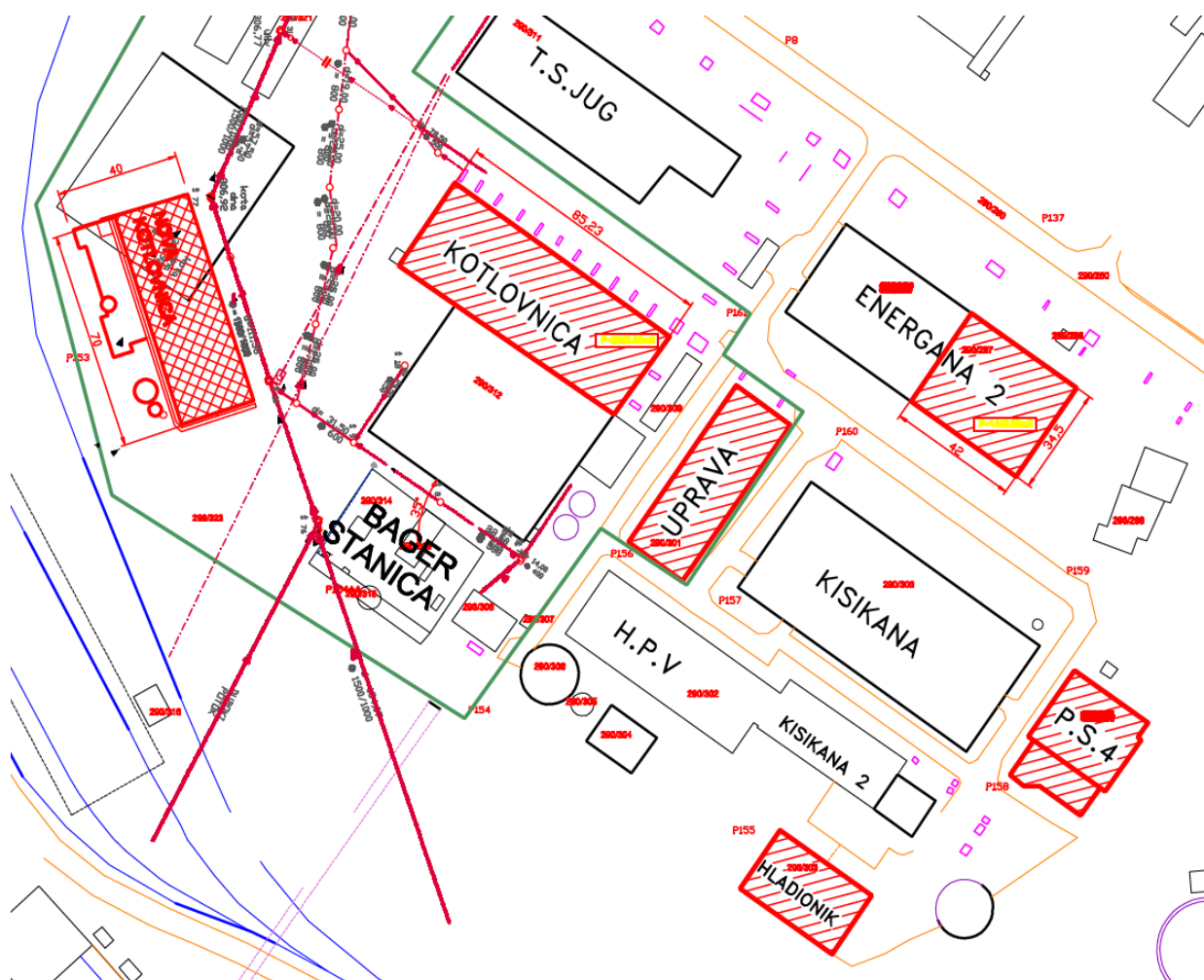
Slika 4. Dispozicija objekata u sastavu kogeneracijskog postrojenja za proizvodnju toplinske i električne energije i komprimiranog zraka
